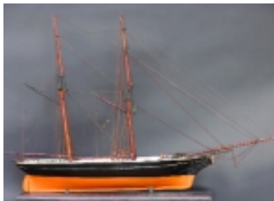
78. Maquette d'un brick goélette présenté à sec de toile. Coque en bois massif sculptée, peinte en noir pour les œuvres mortes et rouge orangé pour les œuvres vives. Buste de jeune femme en figure de proue. Origine probablement bordelaise. Fin 19ème. 65 x 94 cm.
