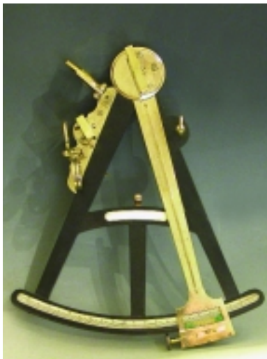
112. Octant en ébène, ivoire et laiton. Visée par pinnule, lecture par vernier. Plaque en os et portemine. Fin 18ème s. Rayon : 33 cm.
