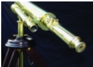
185. Lunette astronomique en bronze et laiton. Mise au point par crémaillère. Chercheur latéral. Montage de parquet sur un tripode en chêne. France, 19ème siècle. Focale: 115 cm.
