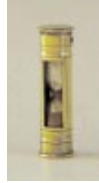
242. Sablier de loch en laiton. Deux ampoulettes pour une durée de 15 secondes. Etui fermant à guichet. Modèle réglementaire, France, 19ème siècle. H. : 5 cm. Photo ci-contre
