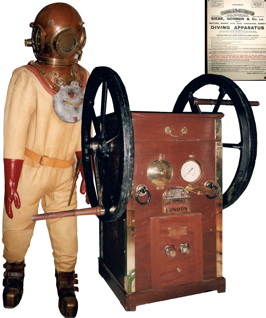
135 Tenue complète de scaphandrier avec une pompe à volants à deux cylindres. Matériel neuf de démonstration des établissements Siebe-Gorman. Angleterre, C. 1920.
